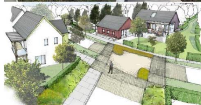
Figure 6 : Illustration d'un aménagement de carrefour limitant la vitesse automobile et favorable à la sécurité des modes doux
